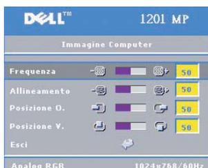
**FREQUENZA** – Consente di modificare la frequenza di clock dei dati visualizzati in modo che corrisponda alla frequenza della scheda grafica del computer in uso. Se si nota una barra verticale con problemi di sfarfallio, utilizzare il controllo Frequenza per ridurre al minimo le barre. Questa è una regolazione di massima.
