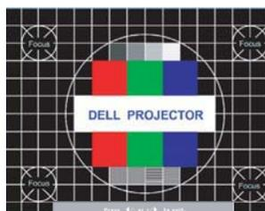
Premere il pulsante del pannello di controllo o il pulsante Menu del telecomando per visualizzare il grafico del motivo di test. Utilizzare questa funzione per regolare la messa a fuoco dello schermo proiettato. Utilizzare il pulsante o del pannello di controllo o il pulsante o del telecomando per uscire da questa modalità.
